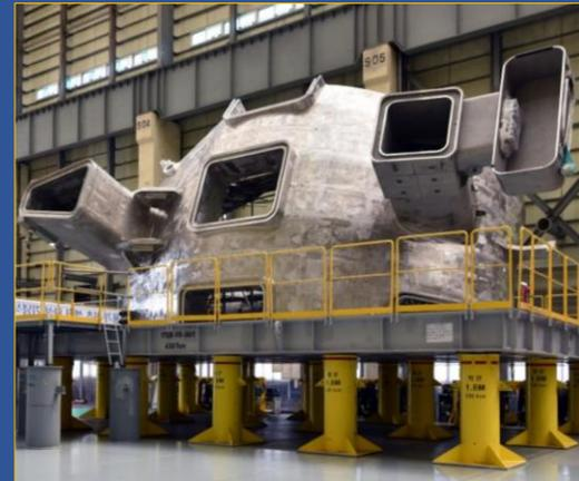
Le secteur de chambre à vide # 6, fourni par la Corée et livré le 22 juillet, sera accouplé aux bobines de champ toroidal # 12 et 13 pour former le premier « pré-assemblage ».
